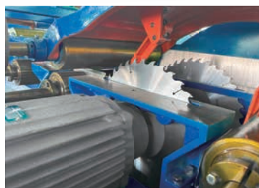
8ECは7.5kw丸鋸モーター
