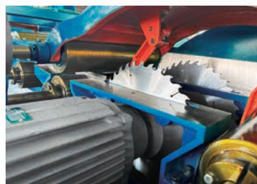
8DLは7.5kw丸鋸モーター
