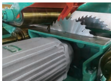
8ECは7.5kw丸鋸モーター
